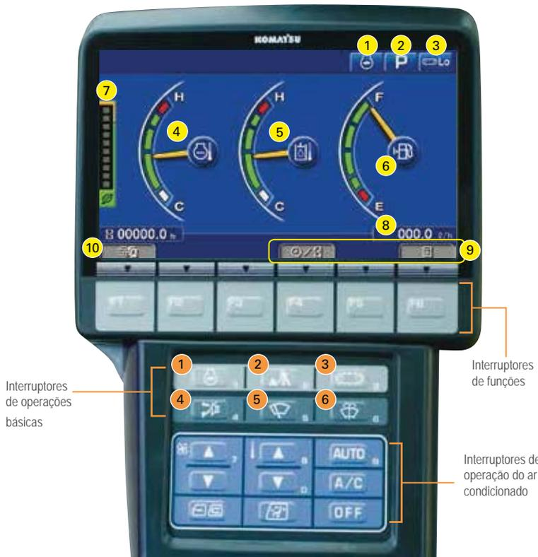
Um monitor a cores sintonizado com o usuário e de grandes dimensões assegura segurança, precisão e suavidade nos movimentos.
