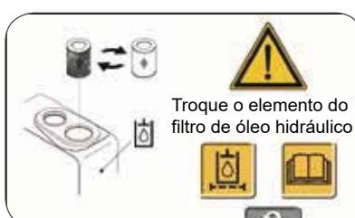
Mensagem de advertência sobre a necessidade de substituição do filtro do óleo hidráulico.
