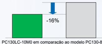
Com base nos padrões de trabalho típicos registrados pelo sistema KOMTRAX. Equipamentos configurados com caçamba de 0,60m<sup>3</sup>. O consumo de combustível pode variar de acordo com as condições de trabalho e utilização.
