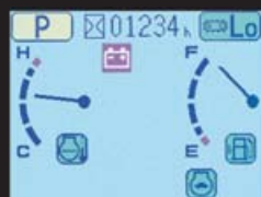
Tela de anormalidade na carga da bateria
